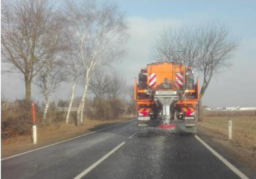
Im NÖ Straßendienst wird seit Jahrzehnten grundsätzlich Feuchtsalzstreuung durchgeführt. Der besondere Vorteil bei dieser Streutechnik liegt darin, dass einerseits eine bessere Haftung und gleichmäßigere Verteilung der Streumittel auf der Fahrbahn erreicht wird, und andererseits eine schnellere Tauwirkung einsetzt.
