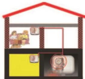
Moderne Heimrauchmelder können miteinander verbunden (vernetzt) werden. Sollte ein Gerät Rauch feststellen (z.B. im Keller), ertönt bei allen angeschlossenen Geräten (z.B. im Wohnraum) das Alarmsignal. Dadurch werden Sie rechtzeitig alarmiert und können sich in Sicherheit bringen.
